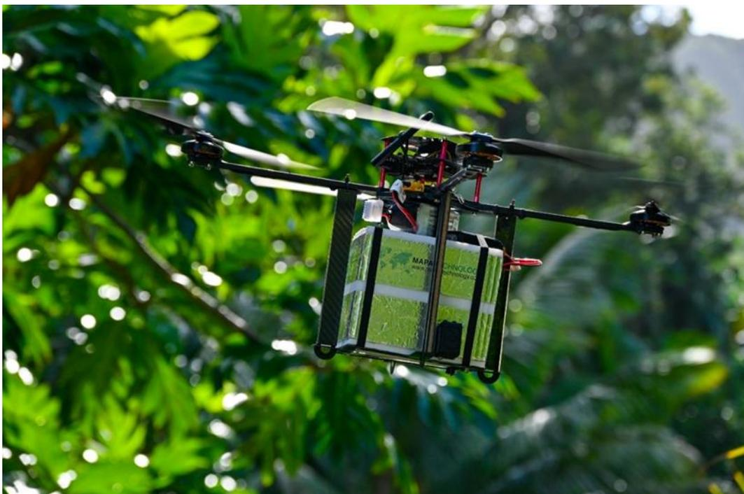
*РИС. В.3. Беспилотный летательный аппарат, выпускающий стерильных самцов комаров (*Aedes aegypti*) на острове Реюньон, Франция. (Источник: МАГАТЭ)*
