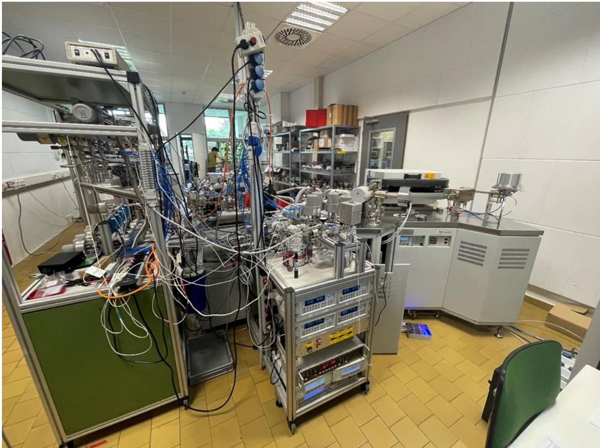
*РИС. В.2. Установленная в Лаборатории изотопной гидрологии новая современная система масс-спектрометрии на базе гелия-3 предназначена для определения концентраций трития методом измерения накопления гелия-3. (Источник: МАГАТЭ)*
