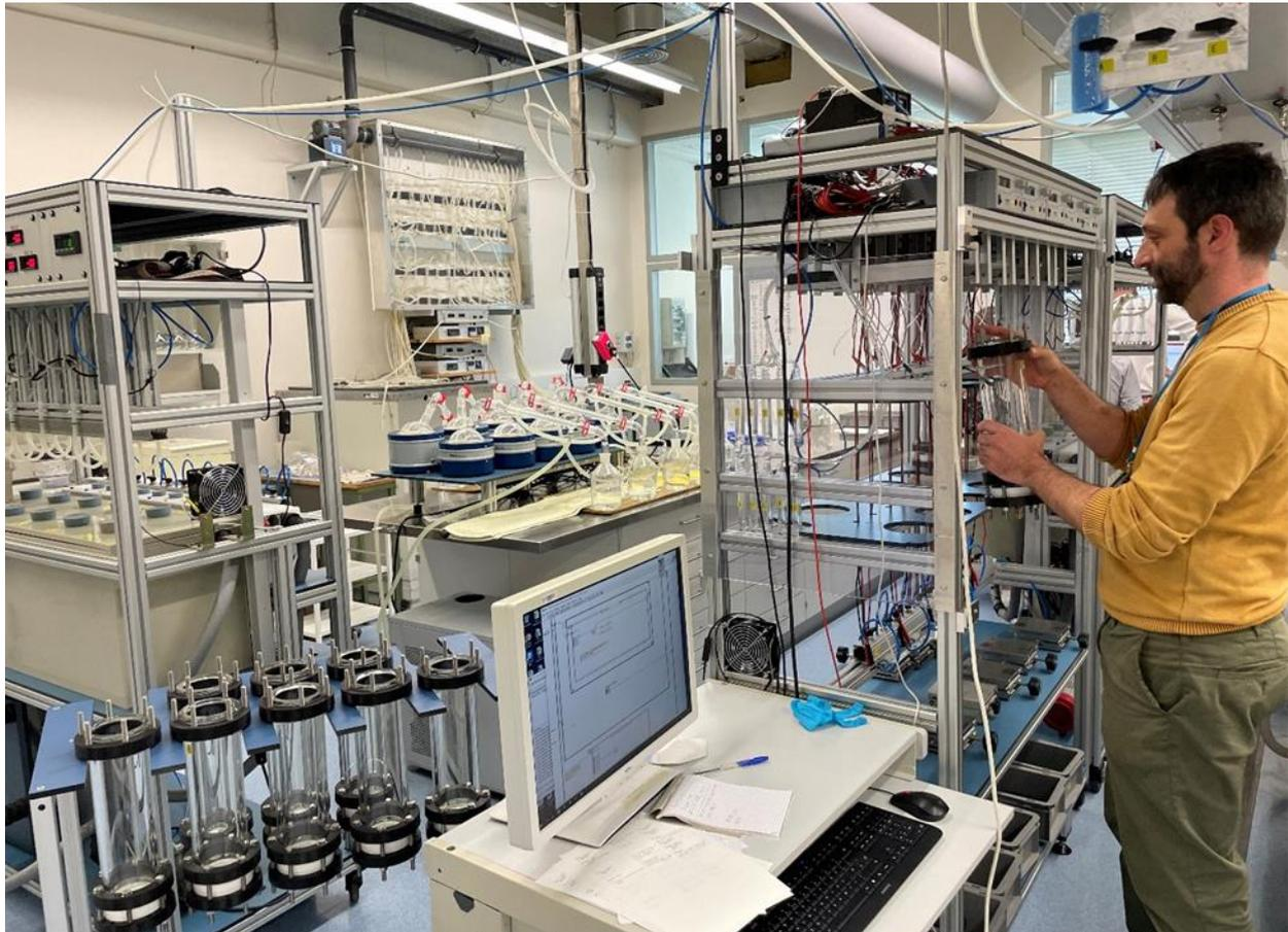
*РИС. В.1. Новый метод обогащения проб тритием с использованием технологии твердых полимерных электролитных мембран (ПЭМ). На заднем плане — дистилляционная система. (Источник: МАГАТЭ)*
