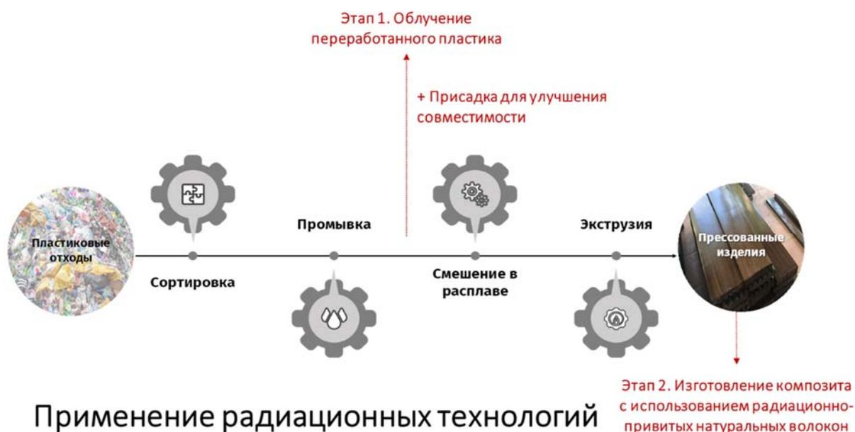
РИС. F-1. Предложенная на Филиппинах схема изготовления композита с использованием радиационно-привитых натуральных волокон и облученного пластика из вторичного сырья.
