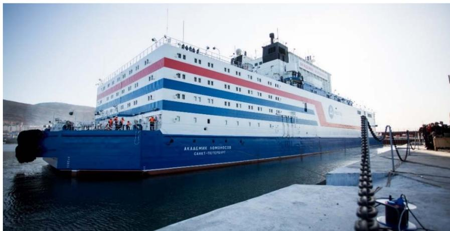
*РИС. А-8. АЭС «Академик Ломоносов» с двумя реакторами КЛТ-40С находится в коммерческой эксплуатации с мая 2020 года и производит 70 МВт (эл.) в Певеке, Российская Федерация.*
