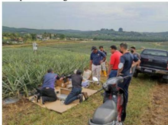
Installation, étalonnage et validation d'un humidimètre à neutrons de rayons cosmiques sur le site de culture d'ananas de Kulim. (Photo : Site d'étude de Selangor)
