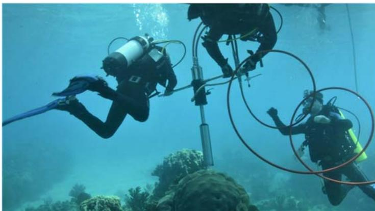
Отбор 230-летнего кораллового керна для исторической реконструкции pH и температур с использованием методов дельта-11Вого и 18Охуген соответственно. (Фото: Луис Ангал Арагон Лопес/ЦЭИС-Куба)
