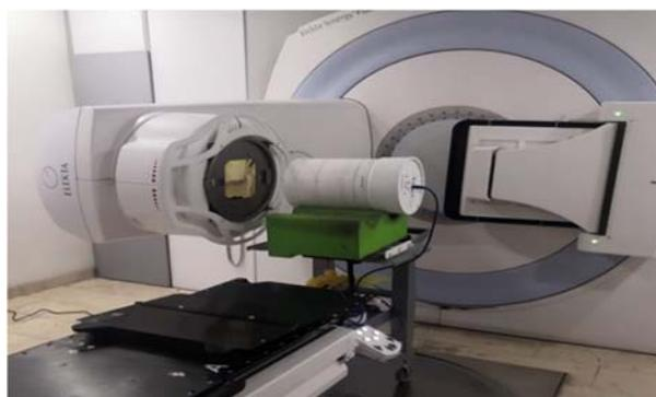
Установка многомерной детекторной решетки с тележкой и программным обеспечением контроля качества для обеспечения более высокого качества лечения и применения передовых методов радиотерапии. (Фото: д-р Муссаб Алабуди)
