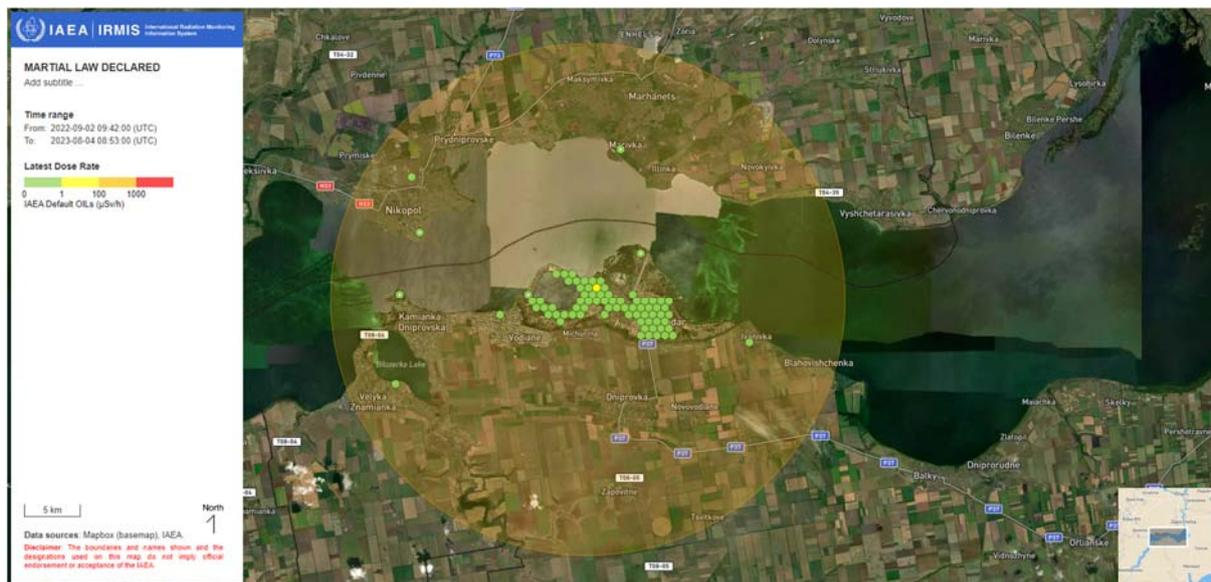
*Datos de monitorización radiológica procedentes de las estaciones de monitorización y mediciones tomadas por el grupo de la ISAMZ dentro de un radio de 20 km alrededor de la ZNPP. Los niveles de radiación son normales.*
