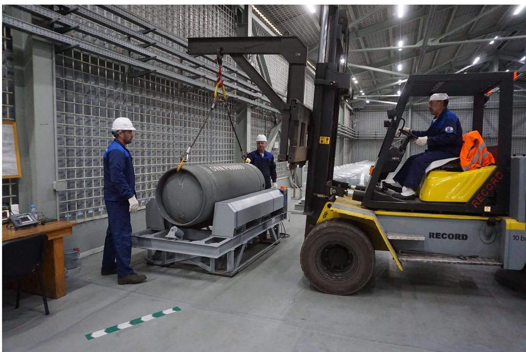
*FIG. B.3. Recertification des cylindres 30B remplis d'UFE à la banque d'UFE de l'AIEA.*
