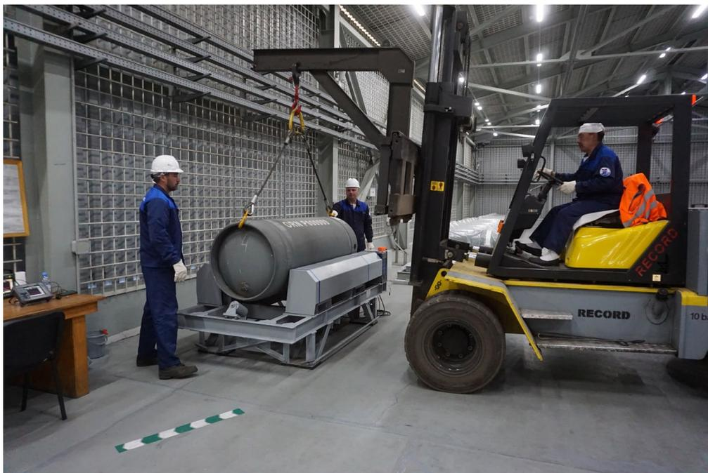
*РИС. В.3. Повторная сертификация заполненных НОУ цилиндров типа 30В
