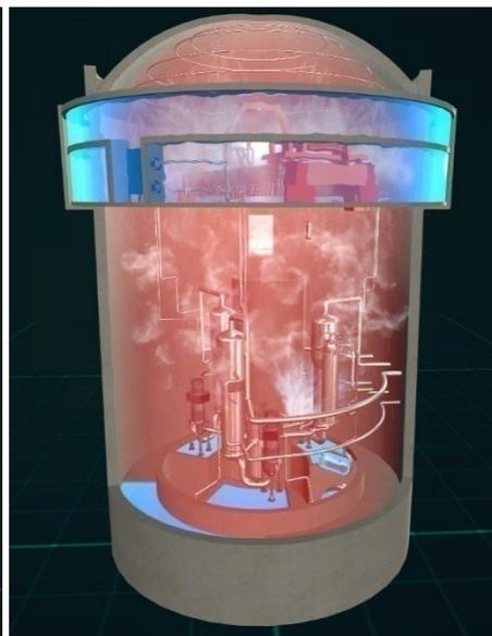
*РИС. В.5. Трехмерное изображение распространения тяжелой аварии, на котором показаны важные системы внутри защитной оболочки, система теплоносителя реактора, спринклерная система защитной оболочки и соответствующие трубопроводы*
