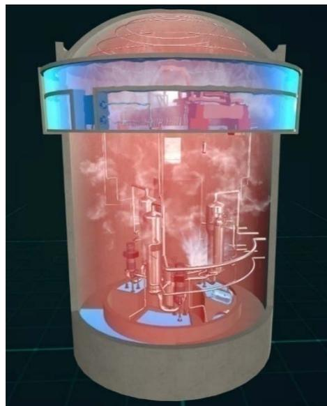
*Fig. B.5. Visualización en 3D de la propagación de un accidente severo, en la que se observan los sistemas importantes dentro de la estructura de contención, el sistema de refrigeración del reactor, el sistema de rociado de la contención y las tuberías correspondientes.*
