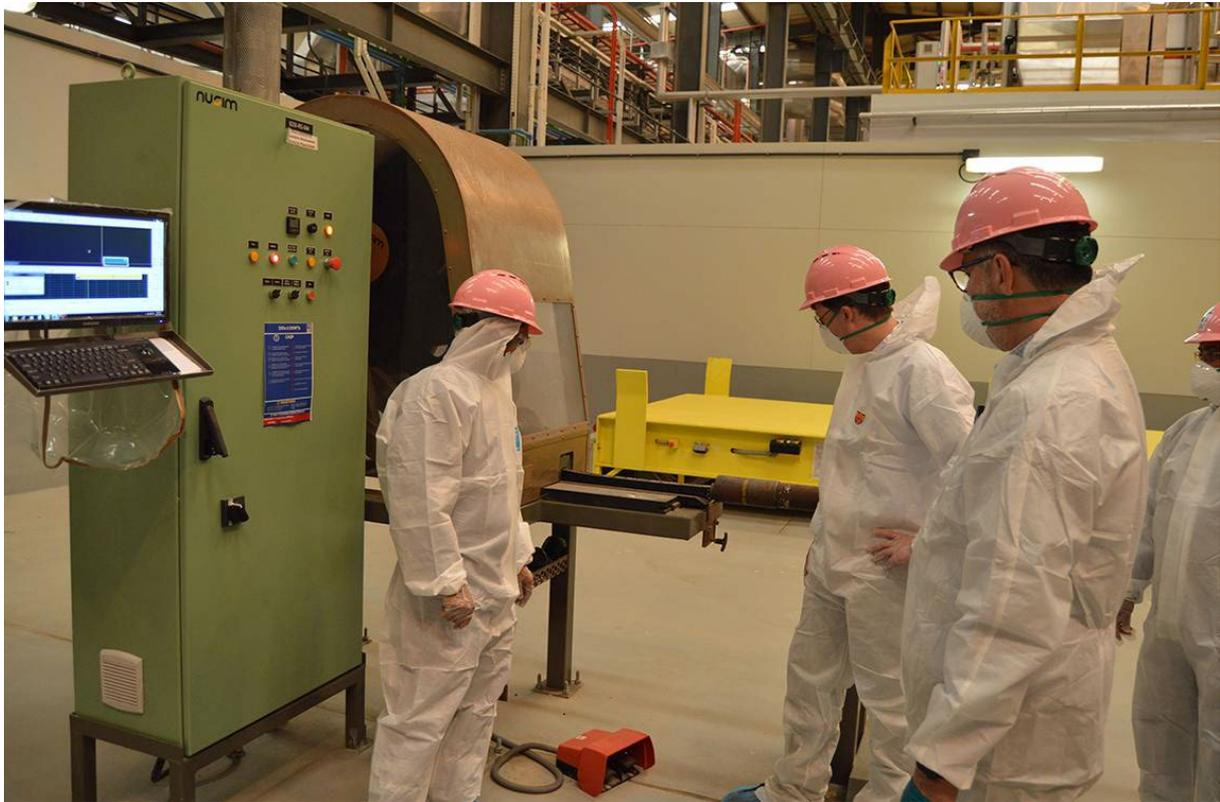
2022年11月，职业辐射防护评价服务评审人员在阿拉伯联合酋长国的阿布扎比炼油公司观察管道解控评定系统，评定管道是否存在天然存在的放射性物质残留物。
