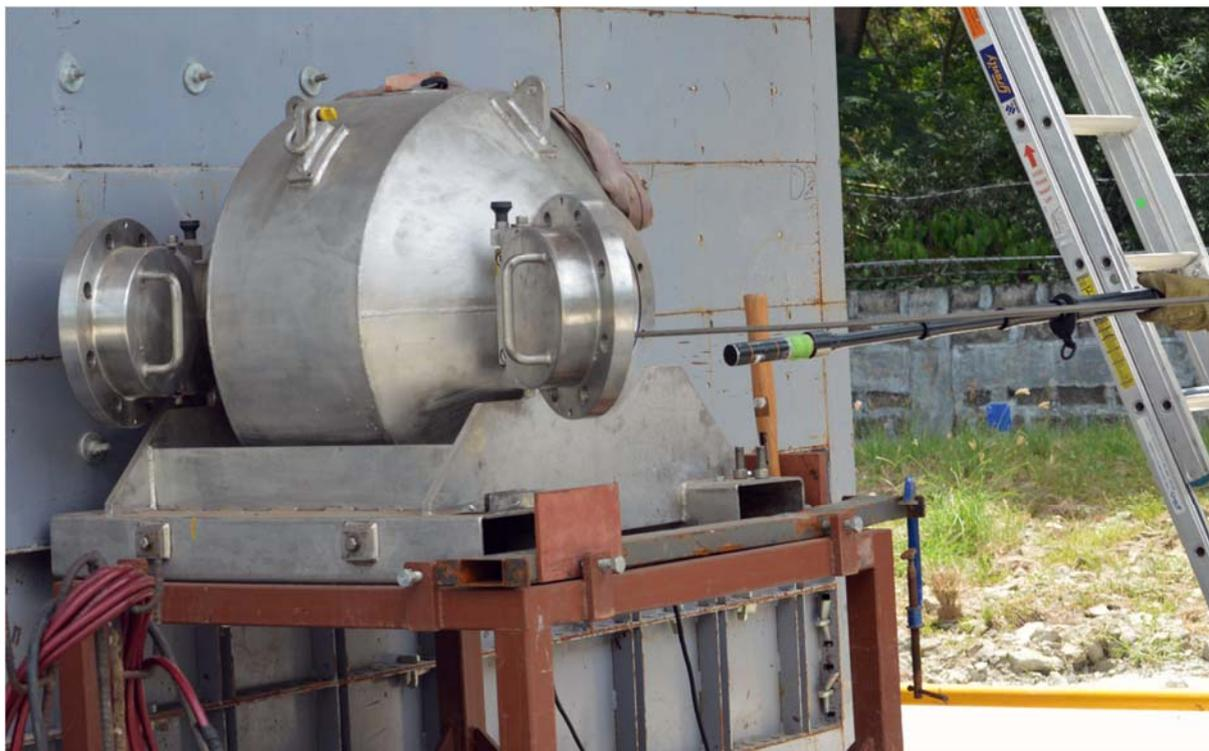
*Retirada de una fuente de radiación gamma para su colocación en una celda caliente móvil*
