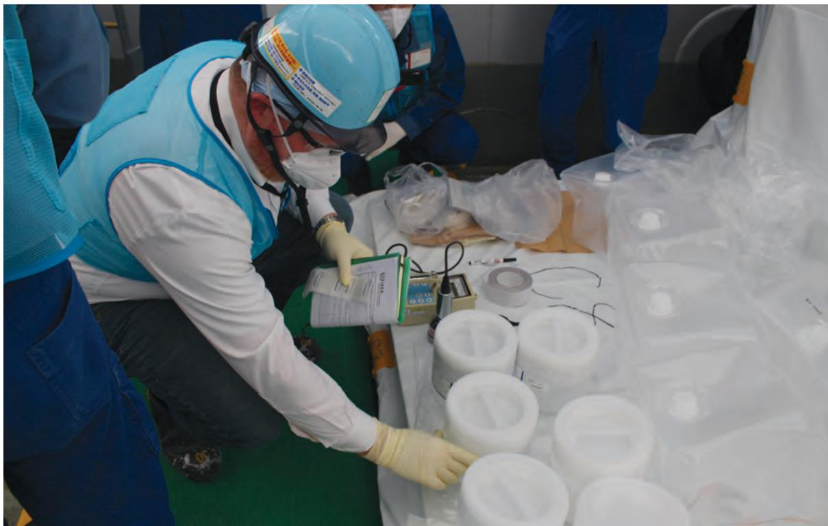
*Эксперт Агентства обрабатывает пробы очищенной с помощью ALPS воды, взятые на АЭС «Фукусима Дайити», для дальнейшего анализа в лабораториях Агентства и сторонних лабораториях.
