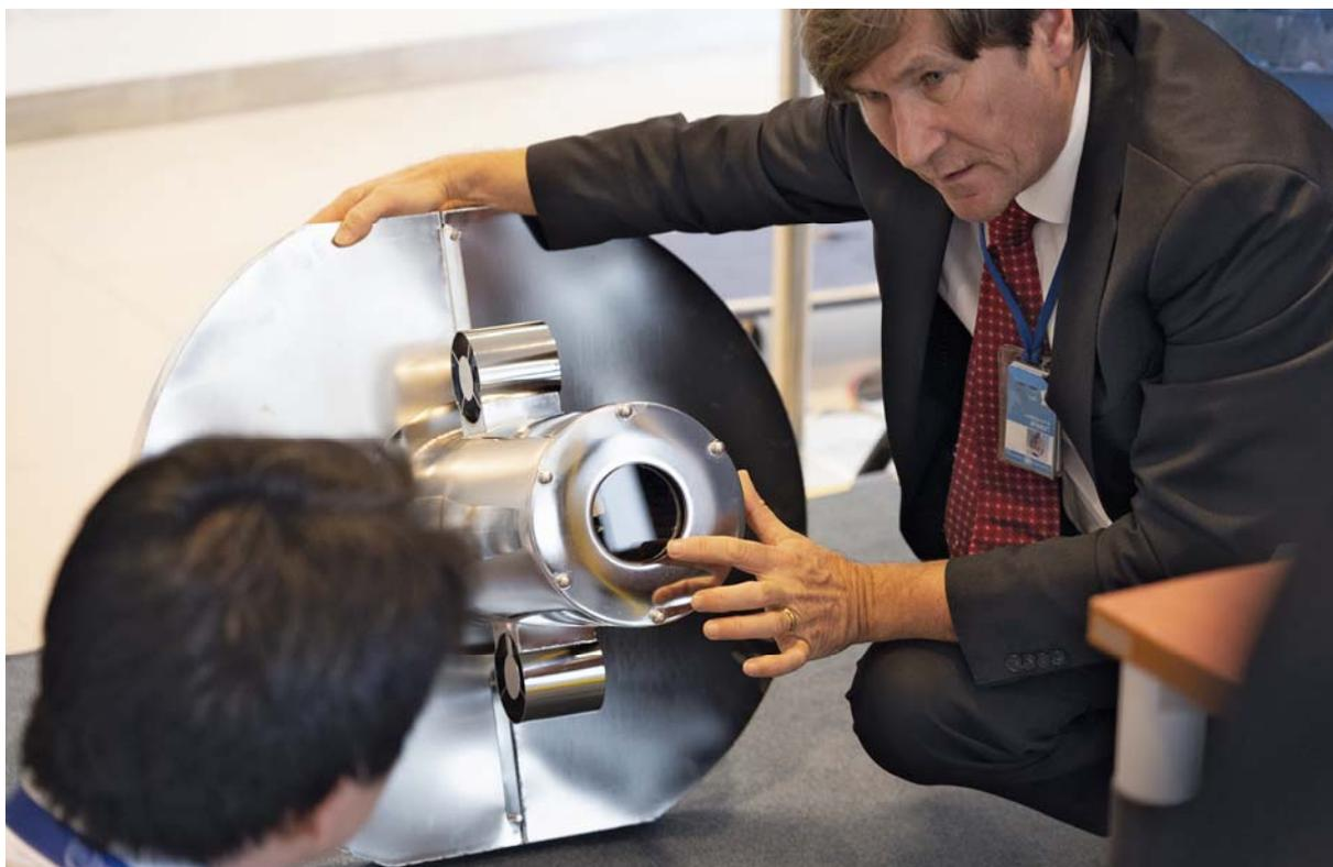
*Un miembro del grupo de instrumentos de análisis no destructivo expone el dispositivo de observación de la radiación Cherenkov robotizado.*
