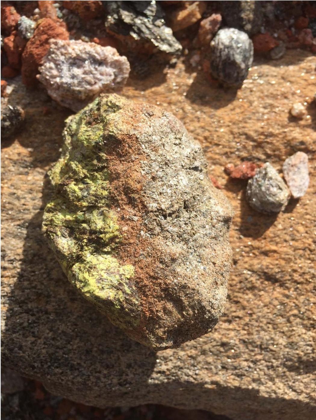
*Fig. C.3. Residuos de la industria minera del cobre con presencia de NORM*
