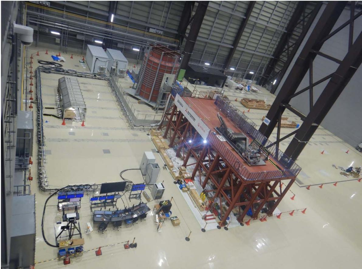
*Fig. C.2. Sala de ensayo de los brazos robóticos y manipuladores para la central nuclear de Fukushima Daiichi (fotografía: Ministerio de Economía, Comercio e Industria del Japón)*
