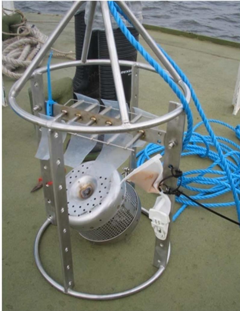
*Fig. I.2. Dispositivos de muestreo pasivo listos para ser desplegados en el mar (fotografía: Centro de Ciencias Ambientales, Pesqueras y Acuícolas del Reino Unido)*
