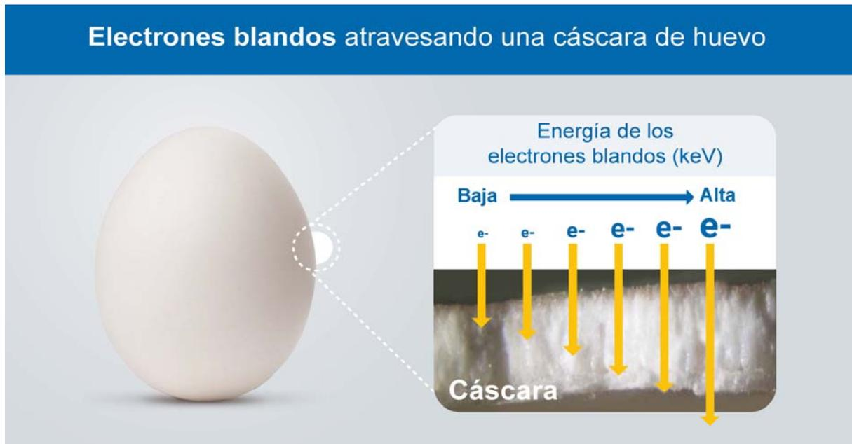
Fig. F.7. Concepto que muestra el uso de electrones blandos ( $e^-$ ) con diferentes energías para penetrar una cáscara de huevo a diferentes profundidades. El objetivo es asegurar que los electrones puedan destruir la salmonela que se encuentra principalmente en o cerca de la superficie de la cáscara de los huevos enteros frescos. (Gráfico: OIEA, basado en el trabajo de N. Takaoka, Instituto Metropolitano de Investigación en Tecnología Industrial de Tokio, Japón)
