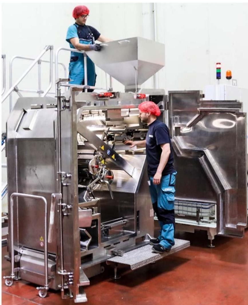
*Fig. F.5. Equipo de procesamiento de alimentos mediante electrones blandos. La máquina Laatu utiliza dos lámparas de electrones de baja energía (las asas rojas en el centro de la foto) para procesar los ingredientes deshidratados a medida que caen a través de un flujo de electrones. Con un consumo energético reducido de hasta un 80 % menos que los métodos que utilizan vapor, ofrece una solución económica para la reducción microbiana. (Fotografía: Bühler)*
