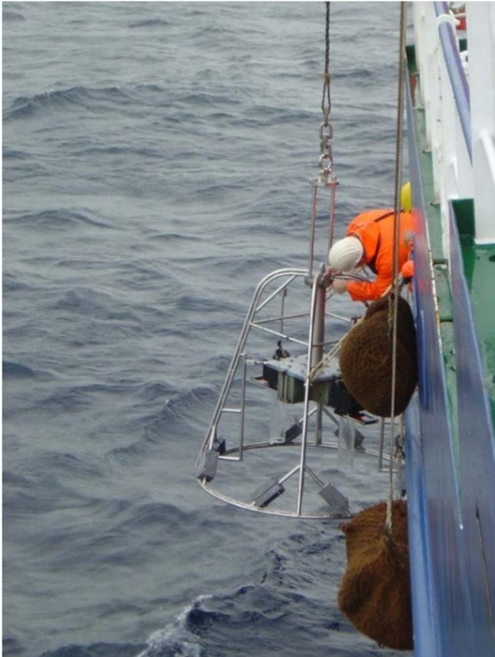
*Fig. I.4. Despliegue de un nucleador múltiple para recopilar muestras de sedimentos inalterados a fin de analizar contaminantes y signos de cambio climático. Los sedimentos conservan información cronológica, y para datar acontecimientos pasados registrados en estos archivos naturales se utilizan radiotrazadores.
