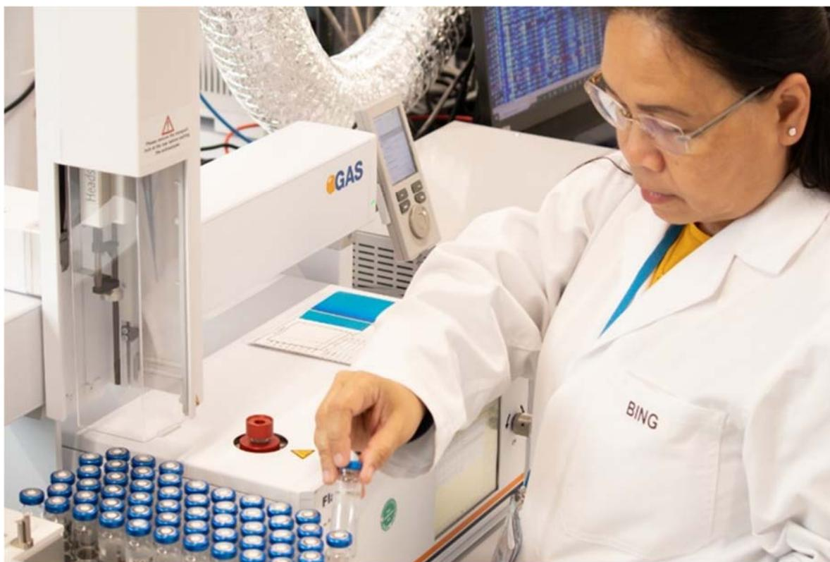
*Fig. F.3. Análisis de cromatografía de gases acoplada a espectrometría de movilidad iónica para detectar las huellas características de contaminantes de los alimentos llevado a cabo en el Laboratorio de Inocuidad y Control de los Alimentos del Centro Conjunto FAO/OIEA de Técnicas Nucleares en la Alimentación y la Agricultura en Seibersdorf (Austria). (Fotografía: OIEA)*
