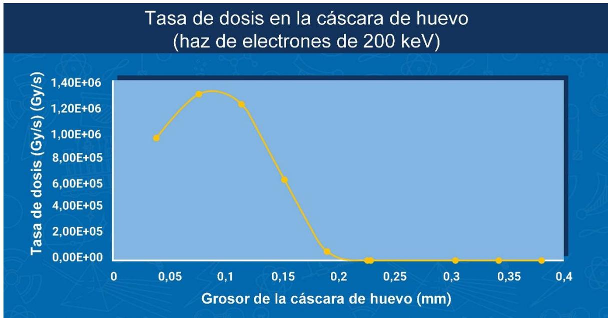
Fig. F.8. Modelo de simulación para calcular el alcance de electrones blandos de 200 keV en cáscaras de huevo y determinar la viabilidad de alcanzar la salmonela a una profundidad de menos de 0,2 mm. (Gráfico: OIEA, basado en el trabajo de Y. Liu, H. Qin, H. Shi de Nuctech Ltd. y H. Zhang de la Universidad de Tsinghua, China)
