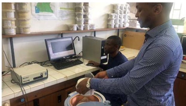
Des chercheurs de l'Institut de recherches géologiques et minières du Cameroun préparent un échantillon de sol aux fins de l'analyse de la concentration de radon. (Photo : AIEA)
