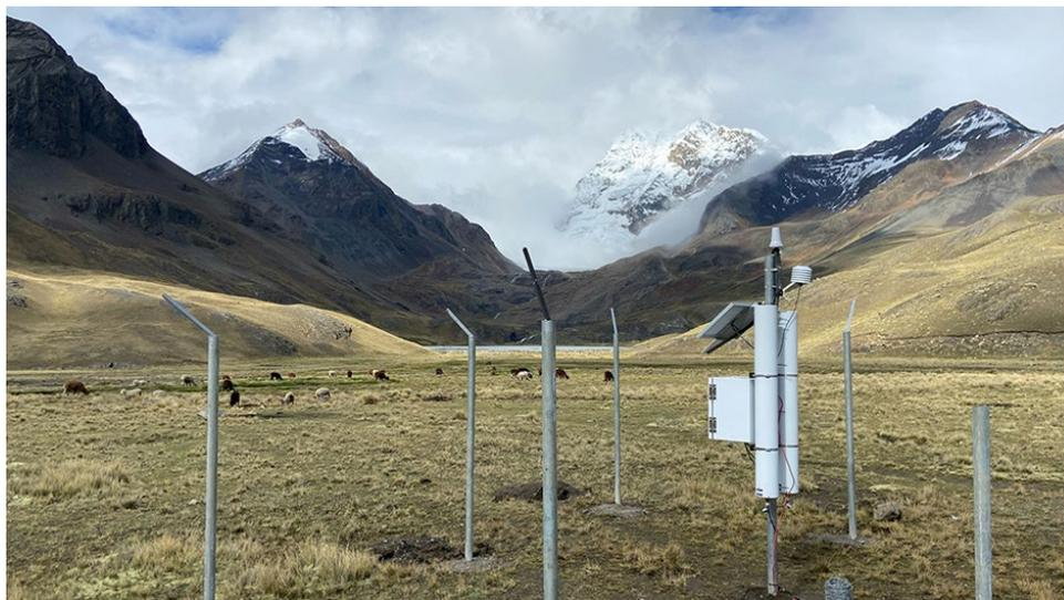
*FIG. I.4 : Humidimètre à neutrons de rayons cosmiques installé à haute altitude dans des zones humides des Andes boliviennes pour l'étude de leur capacité de régulation hydrique en période de changements climatiques.
