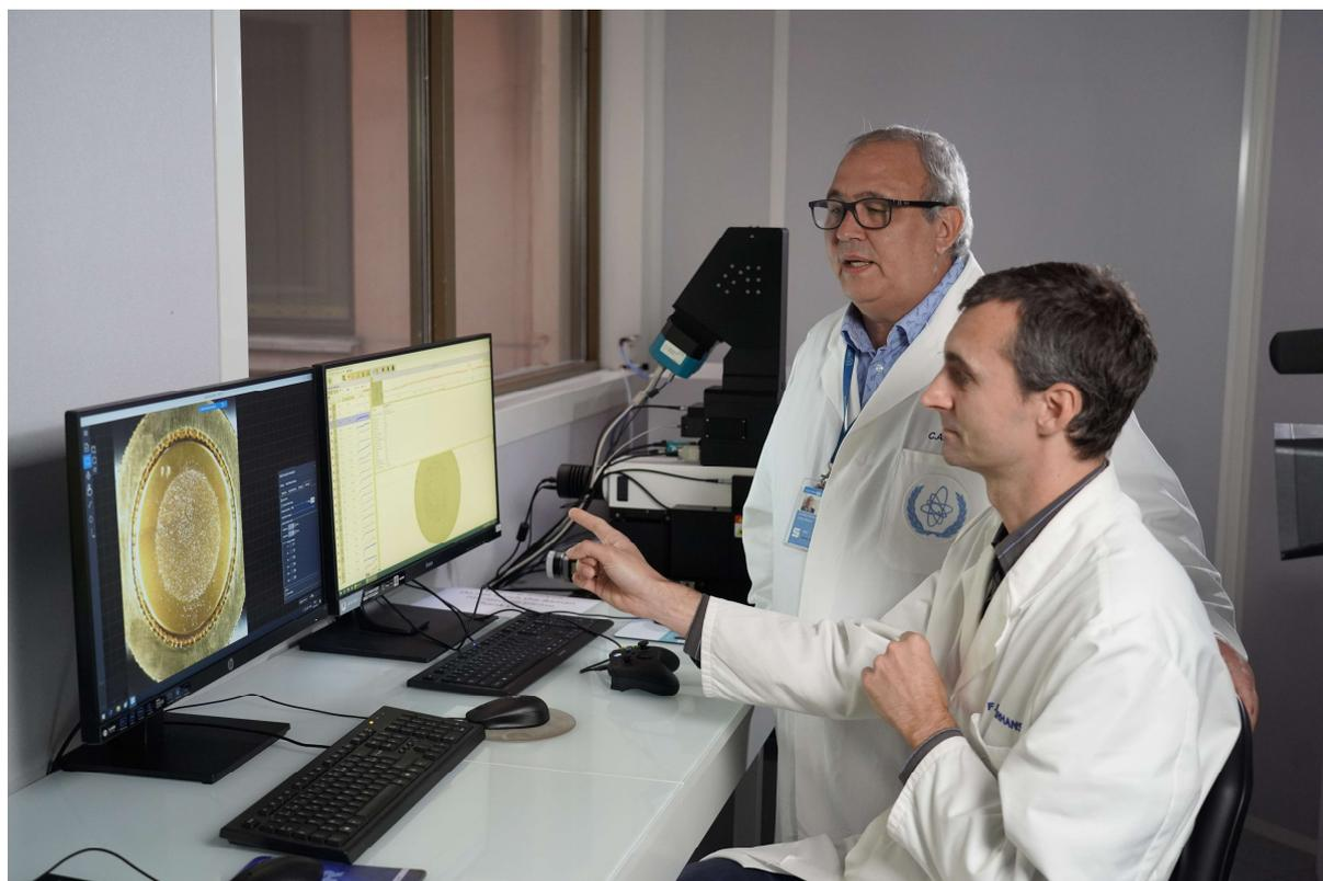
*Fig. L.1. En los Laboratorios del OIEA para el Medioambiente Marino, unos científicos analizan las características químicas de los microplásticos presentes en muestras del medio marino mediante espectroscopia vibracional, espectroscopia Raman y espectroscopia infrarroja por transformada de Fourier. (Fotografía: OIEA)*
