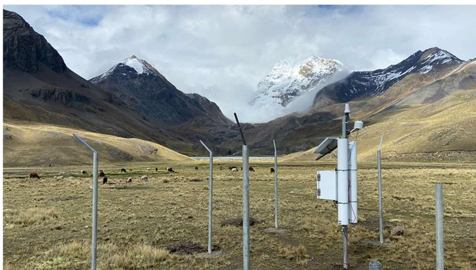
*Fig. I.4. Sonda de neutrones de rayos cósmicos instalada en los humedales altoandinos de Bolivia para estudiar la función de estos como reguladores del agua en condiciones de cambio climático. (Fotografía: T. Franz, Universidad de Nebraska-Lincoln)*
