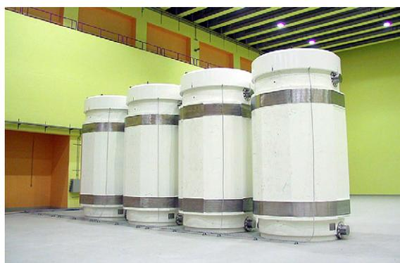
Fig. 2 Almacenamiento provisional y cofres de transporte en la instalación de almacenamiento provisional de ZWILAG, (Suiza).
