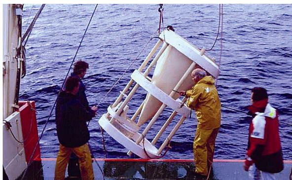
*Fig. 1. Colocación de trampas de partículas para la medición de isótopos de carbono y partículas sumergidas en el océano.*
