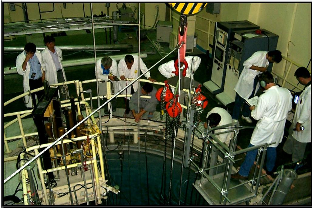
*В Румынии в январе 2005 года, после удаления из активной зоны исследовательского реактора Питешти топлива из ВΟΥ и подготовки этого топлива для репатриации, в указанный реактор было загружено свежее топливо из НОУ.*
