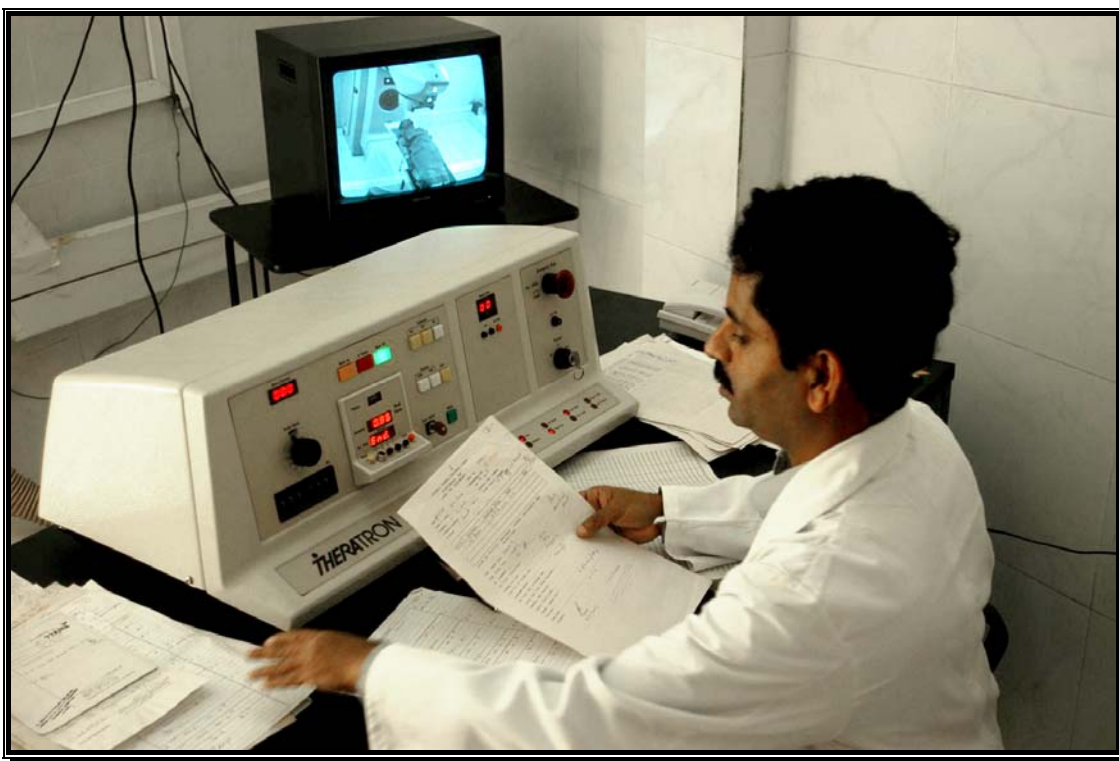
Un físico medico utiliza un equipo de tratamiento radiológico con cobalto en el Kandy General Hospital de Sri Lanka.
