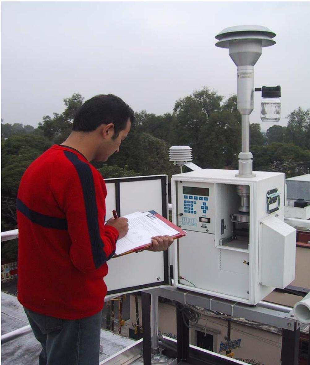
*FIG. 11. Un técnico recoge datos operacionales actuales de un dispositivo para tomar muestras de aire con partículas finas en el emplazamiento de muestreo atmosférico situado en Coyoacán, en la gran Zona Metropolitana de la Ciudad de México (Fotografía por cortesía del Instituto Nacional de Investigaciones Nucleares, México.)*
