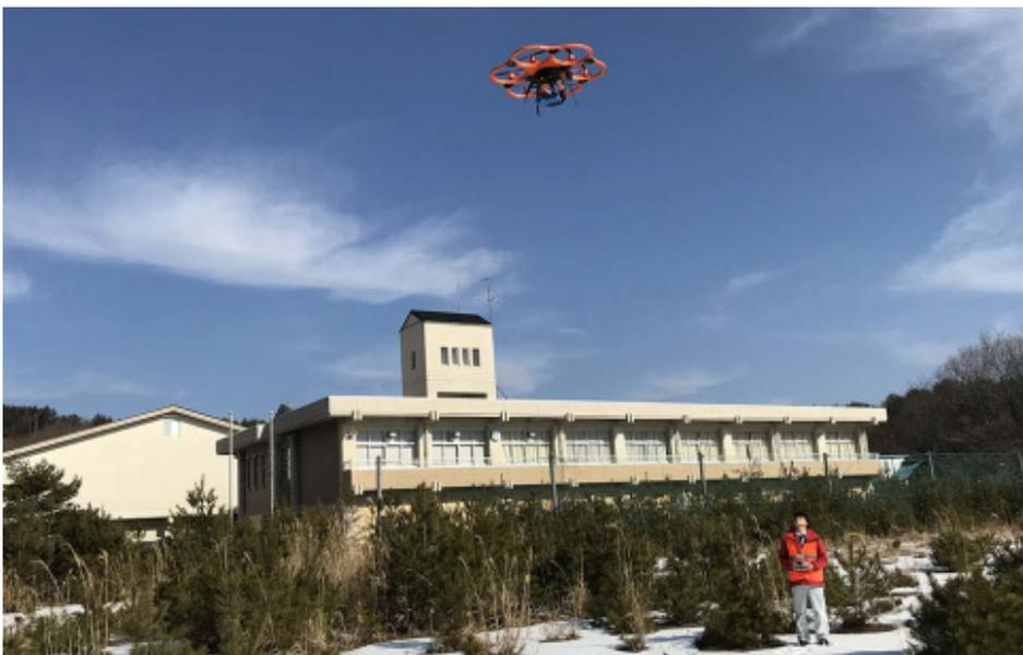
Une nouvelle technologie de drones, mise au point par l'AIEA à l'intention des autorités de la préfecture de Fukushima, au Japon, permet d'effectuer des mesures radiologiques dans les zones contaminées.
