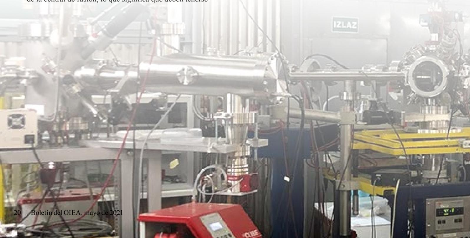
“Tecnologías como la instalación de doble haz de iones construida en 2019 en el Instituto Ruđer Bošković de Croacia con el apoyo del OIEA pueden estimular las condiciones a las que estaría expuesto un material en un reactor termonuclear. Entre ellas la transmutación de un producto y la simulación del daño producido por neutrones y partículas energéticas generados por la fusión”, señala Melissa Denecke, Directora de la División de Ciencias Físicas y Químicas del OIEA.
