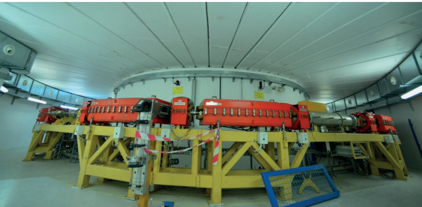
**3** Anillo de almacenamiento interno de la instalación, en el que los electrones empiezan a circular para generar la energía requerida de 2,5 GeV. El anillo de almacenamiento interno, o anillo propulsor, provisto de imanes deflectores y de enfoque, permite que los haces de electrones circulen mientras se van acelerando. A partir de ahí se generan, concretamente, haces de microondas, luz infrarroja, visible y ultravioleta, rayos X y rayos gamma.
