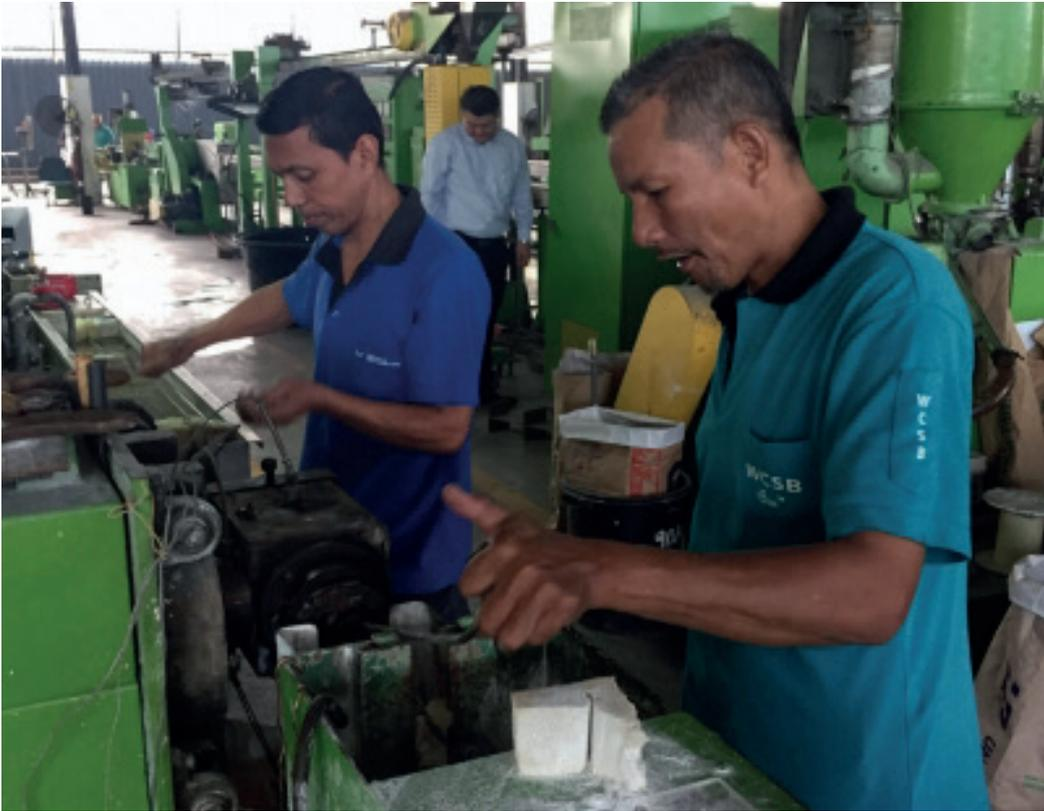
**Cables como estos que fabrica Wonderful Ebeam Cable formarán parte del compartimento motor de automóviles. Los cables adquieren propiedades termorresistentes e ignífugas al ser sometidos a irradiación.**
