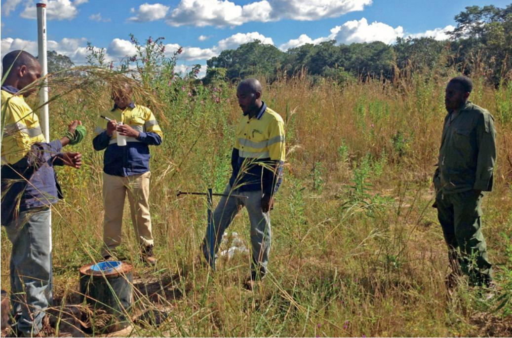
**Muestreo ambiental en el río Mkuju para medir las condiciones de radiación de fondo antes de empezar la extracción.**
