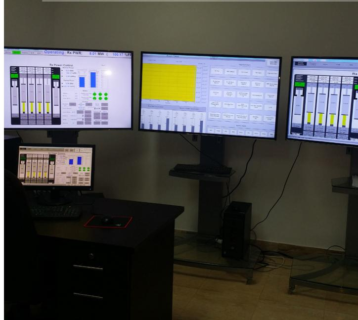
Aux fins de la formation des opérateurs et des ingénieurs en technologie nucléaire du réacteur jordanien de recherche et de formation, le centre de formation de ce dernier est équipé d'un simulateur pleinement fonctionnel. Le simulateur aide les apprenants à comprendre et à mettre en pratique tout ce qu'il faut savoir sur le fonctionnement d'un réacteur de recherche, notamment les scénarios d'incidents liés à la sûreté possibles, afin de bien les préparer à exploiter le réacteur.
