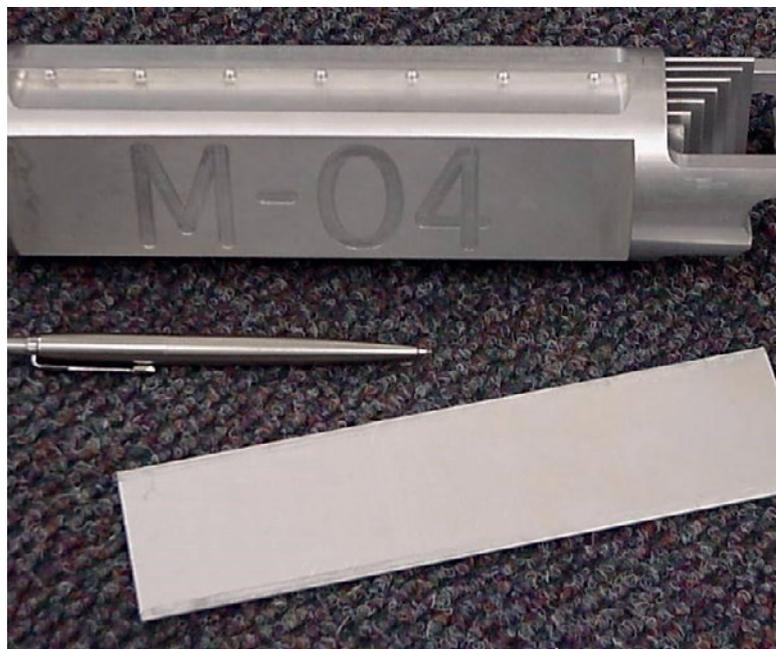
**Placa de blanco de molibdeno 99 y el soporte utilizado para irradiar las placas en un reactor de investigación.**
