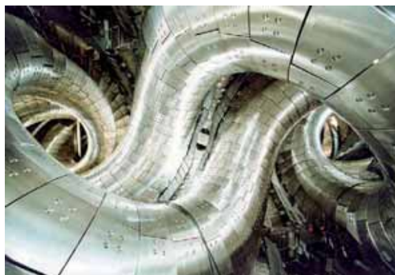
FIG. 2. Vista del interior de la cámara de vacío del estelarator LHD japonés – concepto toroidal del confinamiento para fusión nuclear – que muestra el sistema de serpentines recubiertos de forma helicoidal. El plasma de fusión está confinado por los serpentines dentro de la cámara de vacío.
