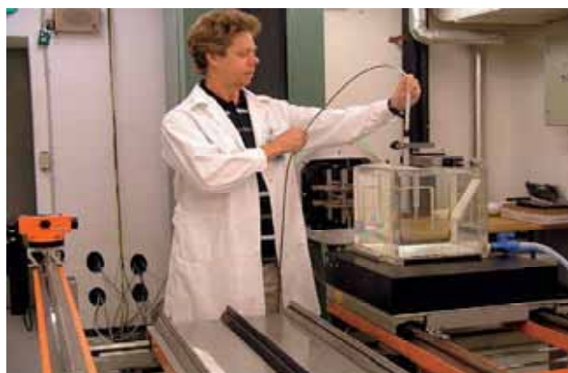
FIG. 3. La exactitud de las mediciones de dosis de radiación resulta vital en radioterapia. En la foto, un físico de los laboratorios del Organismo en Seibersdorf calibra un dosímetro que será utilizado en un Estado Miembro.
