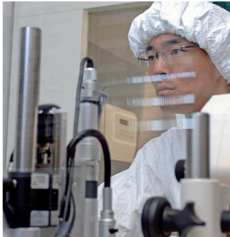
**L'analyse d'échantillons d'environnement est l'un des fondements des garanties. Ici, un technicien du Laboratoire des garanties de l'AIEA, à Seibersdorf (Autriche), examine des particules d'uranium au microscope optique.**
