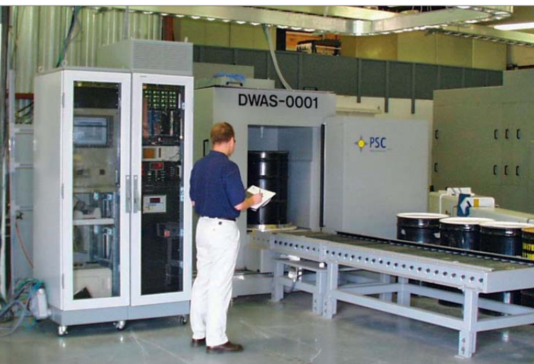
Пассивно-активная система анализа нейтронного потока методом дифференциального затухания (PANDDATM) – система гамма-спектрометрии высокого разрешения с устройством контроля контейнеров. (Фото: "Пахарито сайентифик корпорейшн", США)
