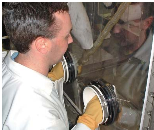
Сортировочный бокс для разделения отходов. (Фото: "Данрей сайт ресторейшн, лтд." и Управление по выводу из эксплуатации ядерных объектов (УВЭ), Соединенное Королевство)
