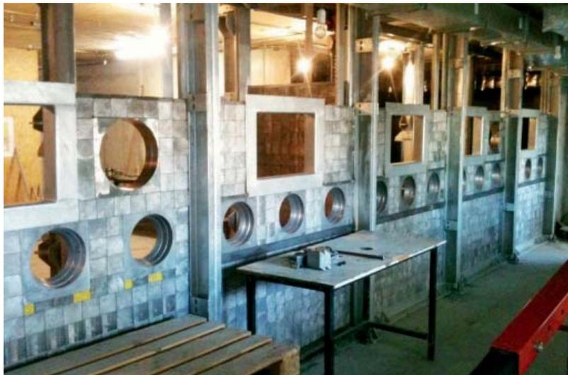
**5** Горячие камеры для производства радиофармпрепаратов на основе технеция-99m и иода-131 изготавливались с окнами из свинцового стекла и запорными рамами для монтажа манипуляторов. МАГАТЭ поставило для лаборатории окна из свинцового стекла и манипуляторы, которые установили техники, работавшие вместе с сотрудниками Чилийской комиссии по ядерной энергии.
