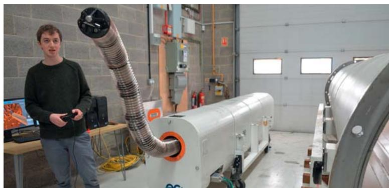
**Змееподобный робот с лазерным резаком позволяет группе по выводу из эксплуатации получить доступ к закрытым и опасным участкам.**
