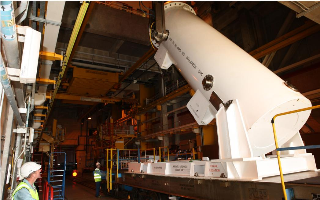
Le combustible utilisé est transporté dans des châssis de transport spécifiquement conçus pour protéger les personnes des matières radioactives qu'ils contiennent et pour résister à de graves accidents de transport sans entraîner de fuites importantes.
